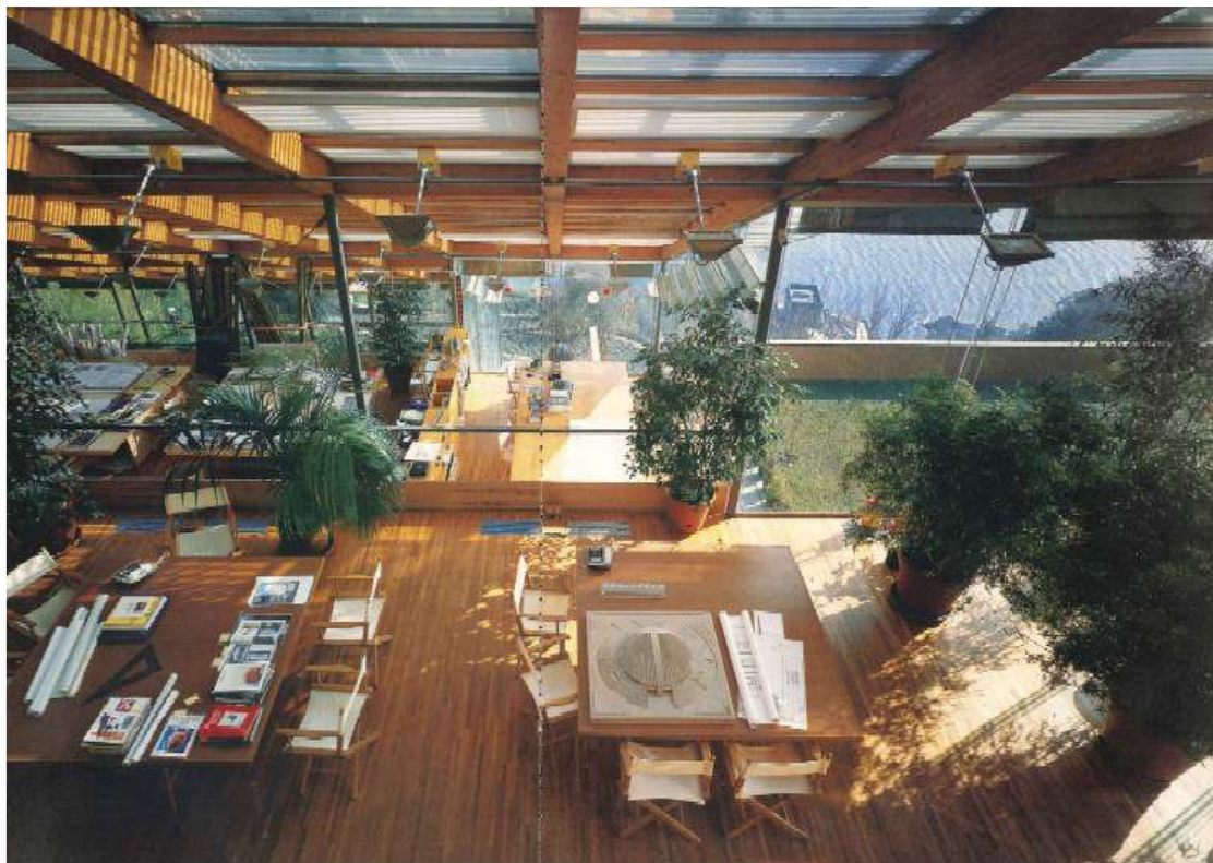
Laboratorio per ricerche naturali "Unesco - Renzo Piano Building Workshop " a Genova-Crevari: serra-laboratorio su più livelli in cls, acciaio e legno lamellare
