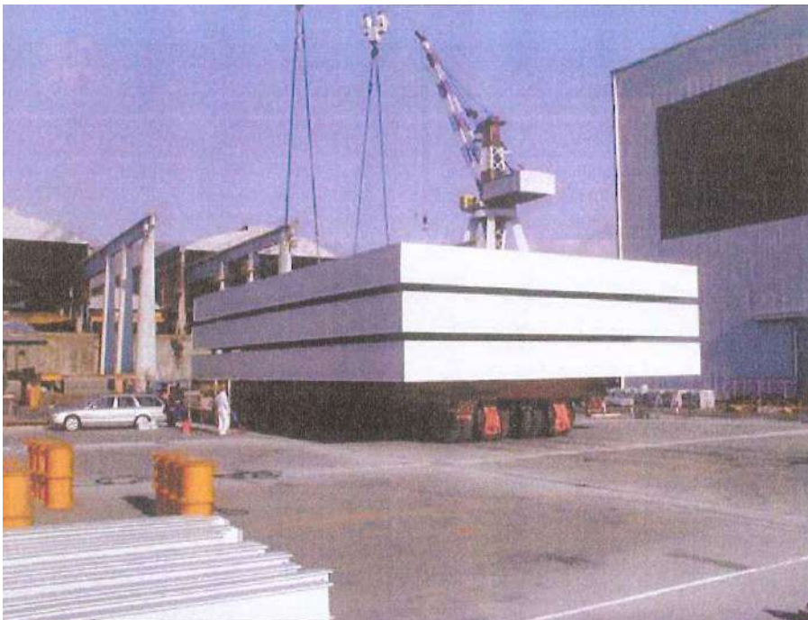
Fincantieri S.p.a. - Cantiere di Sestri Ponente: Collaudo strutture in acciaio per copertura Bacino 2: Posizionamento carro Scheuerle per prove di carico su impalcato in acciaio
